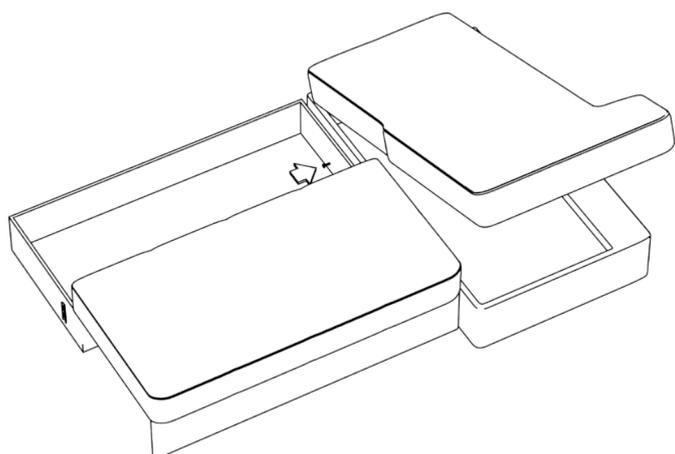
1. Оттоманку и основное сиденье (механизм дельфин нужно будет выдвинуть) скрепляем между собой болтом 1 шт.
